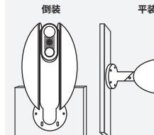
请用户按照说明书方式正确安装，禁止错误方向安装，否则存在因进水导致设备报废风险！
